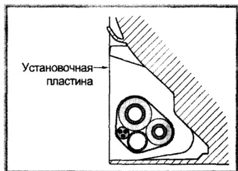
Рис. П3.22. Размещение пучка из трубок, кабеля и дренажного шланга в нижней части комнатного блока
