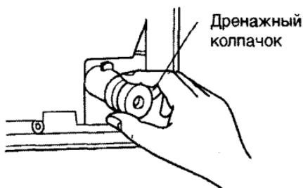
Рис. П2.11. Снятие дренажного колпачка
