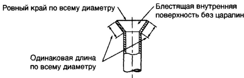
Рис. П2.23. Проверка развалицовки
