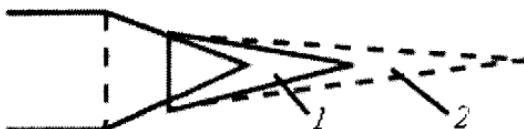
Рис. П1.1. Оптимальный вид пламени горелки для пайки твердым припоем:
