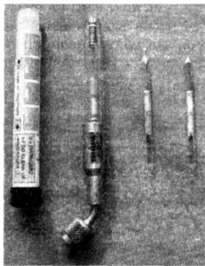
Рис. 5.27. Прибор для оперативного определения степени влажности хладагента
