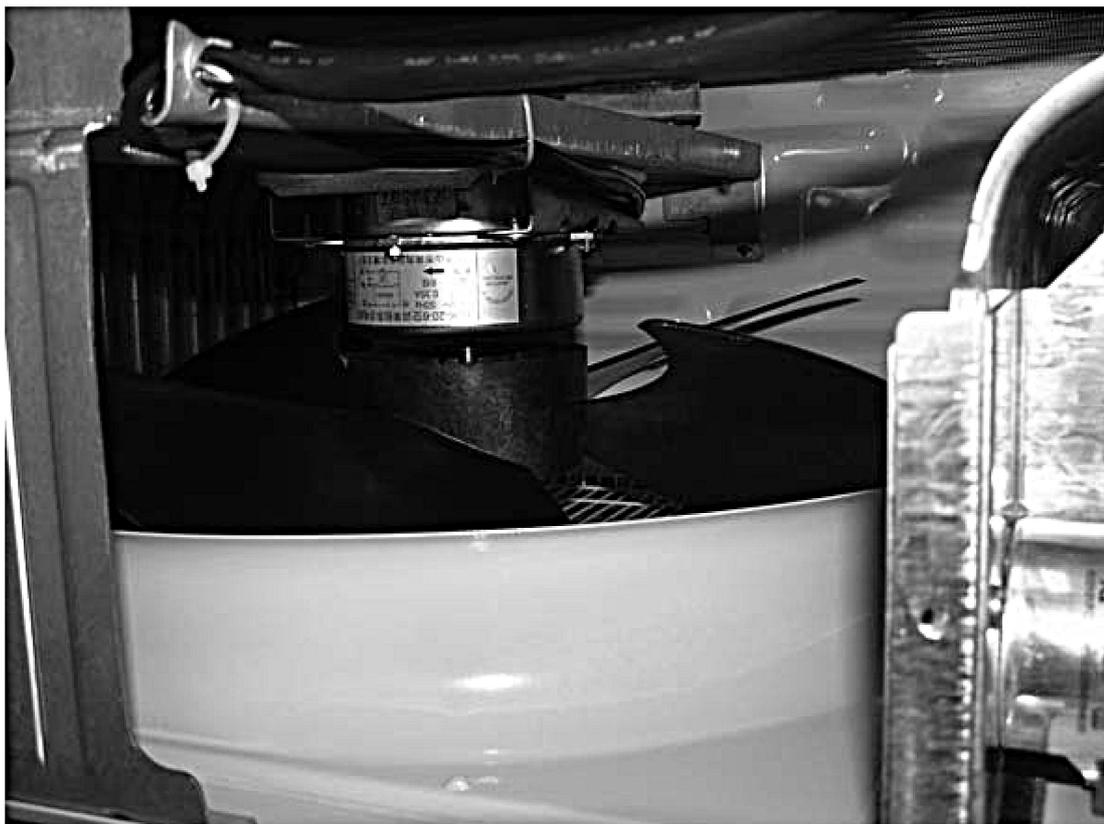
Рис. 1.6. Вид на электродвигатель вентилятора
