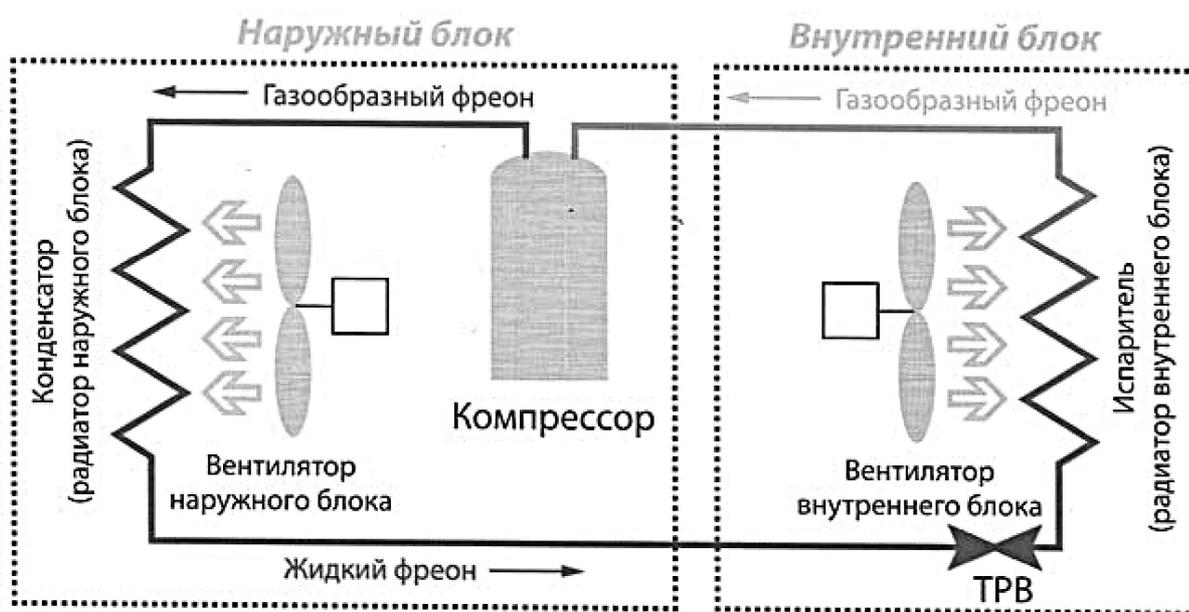
Рис. 1.2. Схема работы кондиционера
