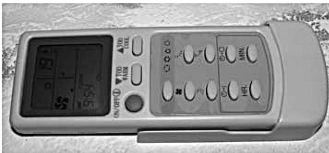
Рис. 3.18. Внешний вид ПДУ системы кондиционирования Haigao KFR25W/SV
