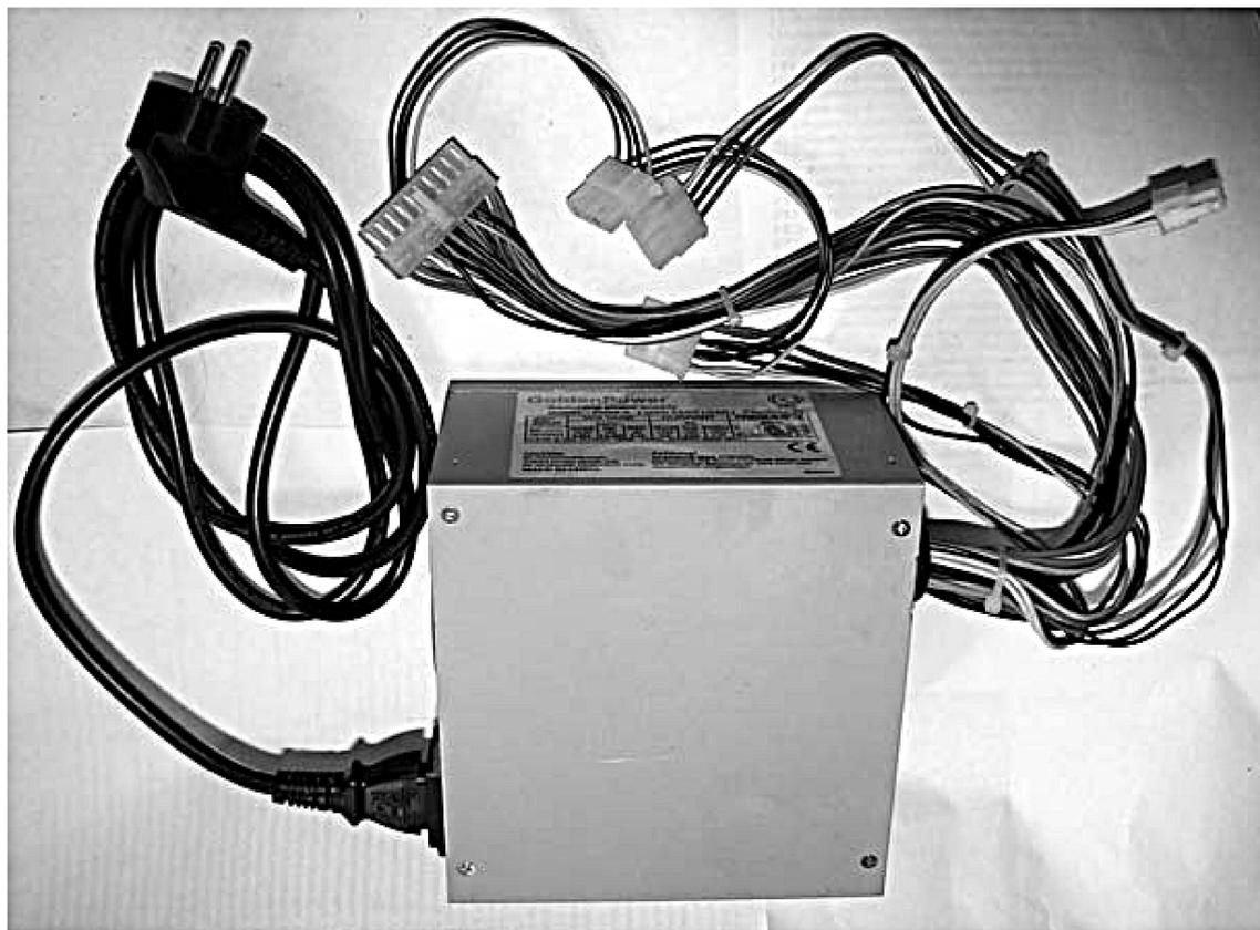
Рис. 5.1. Внешний вид БП ПК типового ряда ATX12
