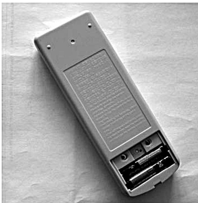
Рис. 3.19. Вид на пульт со стороны отсека батарей и кнопок сброса программирования
